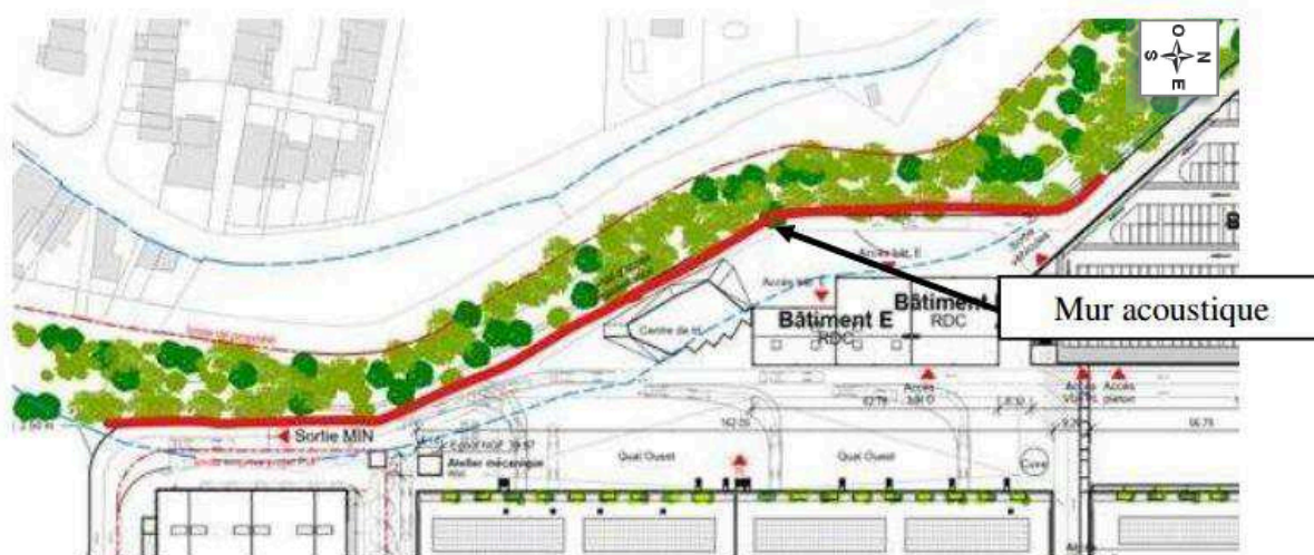
Figure 1e : Insertion du mur acoustique au plan
